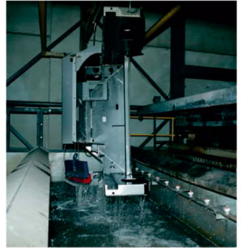
Voorbehandeling: voorbehandeling met dompel- en spuitprocessen in 9 zones met zinkfosfaat coating.
