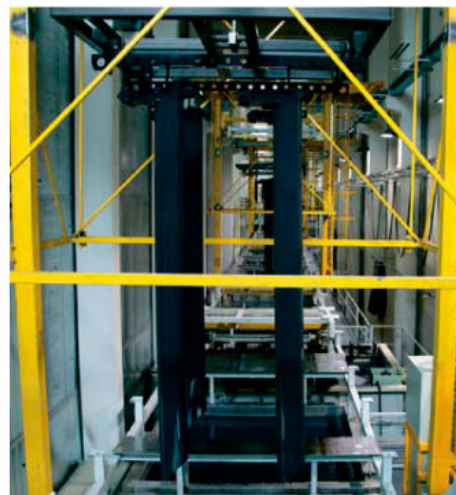
In de afzonderlijke dompelbaden (13 in totaal) worden de kraancomponenten ontvet, gespoeld, geactiveerd, met zink-fosfaat gecoat, opnieuw gespoeld, gepassiveerd en na een spoeling met bijzonder schoon water door middel van onderdompeling elektrostatisch voorzien van de KTL-coating
