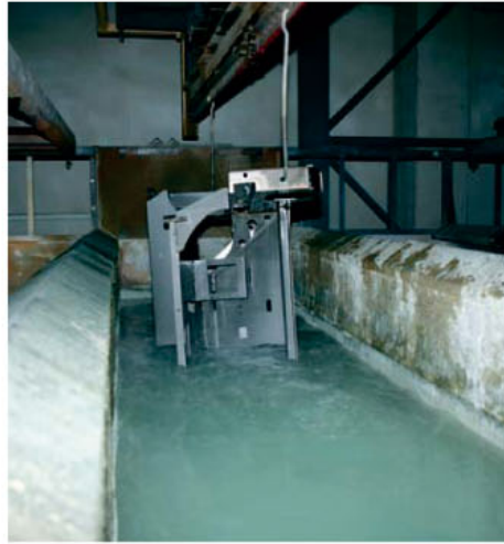
Voorbehandeling: voorbehandeling met dompel- en spuitprocessen in 9 zones met zinkfosfaat coating.
