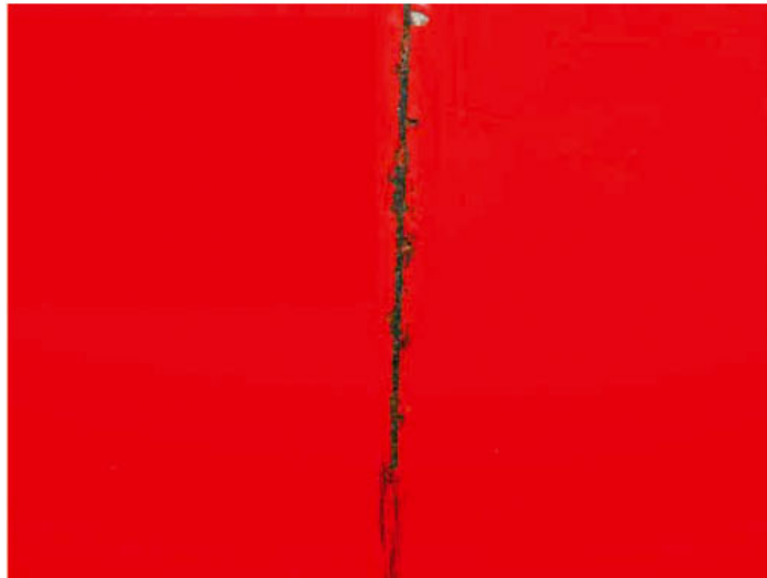
Oppervlak MET KTL-coating na 1152 uur zoutsproeitest
