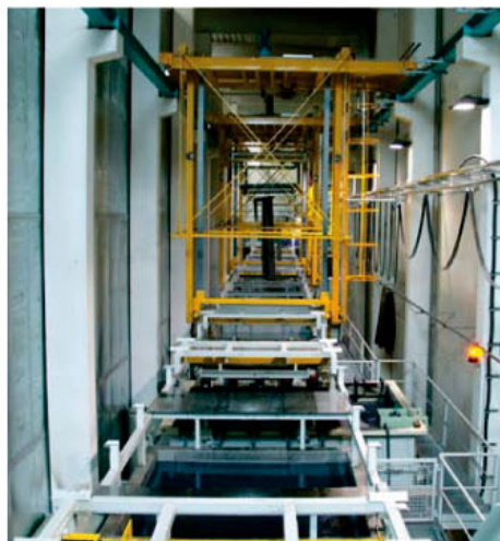
In de afzonderlijke dompelbaden (13 in totaal) worden de kraancomponenten ontvet, gespoeld, geactiveerd, met zink-fosfaat gecoat, opnieuw gespoeld, gepassiveerd en na een spoeling met bijzonder schoon water door middel van onderdompeling elektrostatisch voorzien van de KTL-coating
