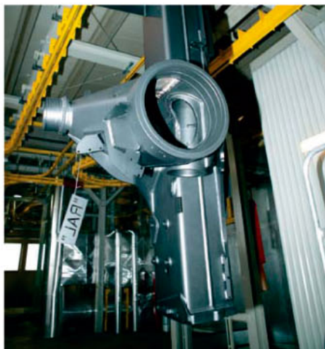
Draadkorrel-gestraald basisframe voorbereid voor het dompelbadprocedé
