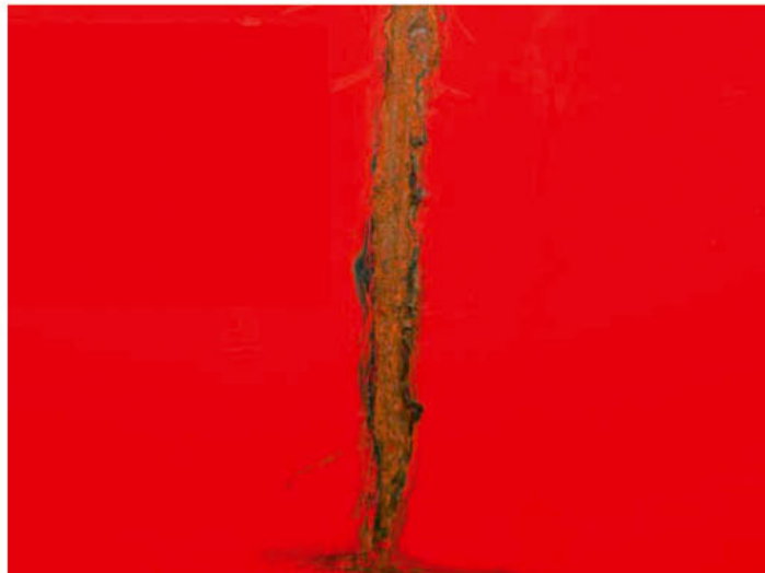
Oppervlak ZONDER KTL-coating na 700 uur zoutsproeitest
