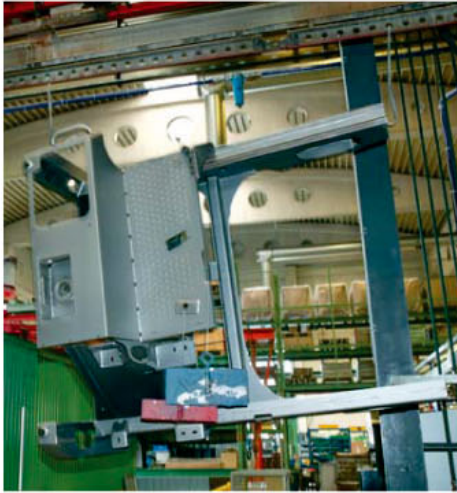
Gestraald component van een CRAYLER meemheftruck voor het dompelproces
