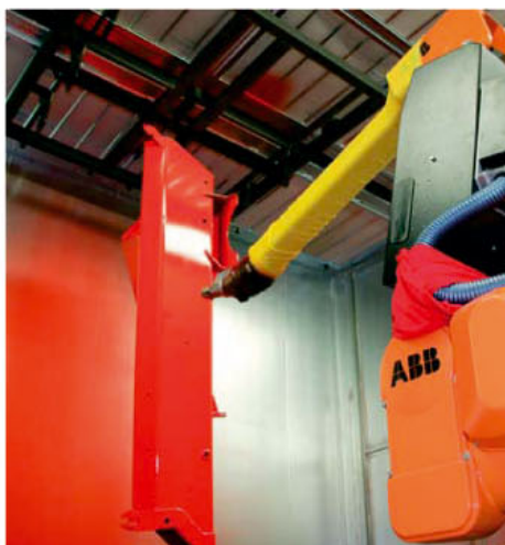
Aanbrengen van een deklaag van waterverdunbare en milieuvriendelijke tweecomponenten-lakken
