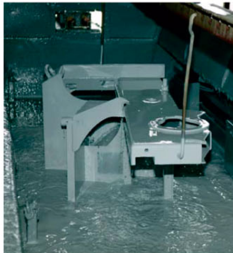
Grondering: elektro-kathodische lakprocedure in 3 zones op waterlakbasis
