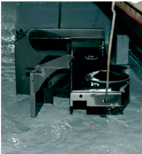
Grondering: elektro-kathodische lakprocedure in 3 zones op waterlakbasis
