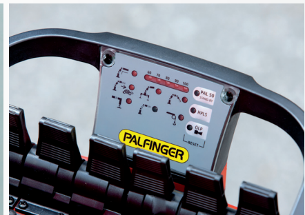
Radiografische besturing* In dialoog met de gebruiker PALFINGER radiografische besturingen zijn uitgerust met lineair en joysticks naar keuze. Bij alle SLD 5 modellen wordt de kraanmachinist via een LED-Display over verschillende bedrijfstoestanden geïnformeerd.
