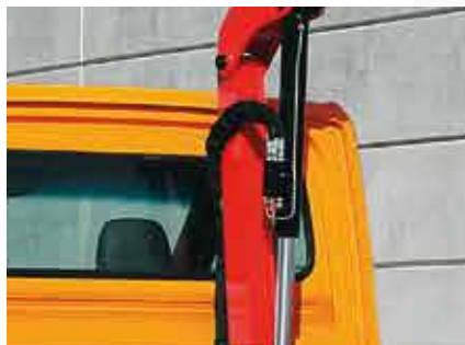
Hydraulische beveiligingsinrichting tegen overbelasting Ingebouwde veiligheidsfunctie
