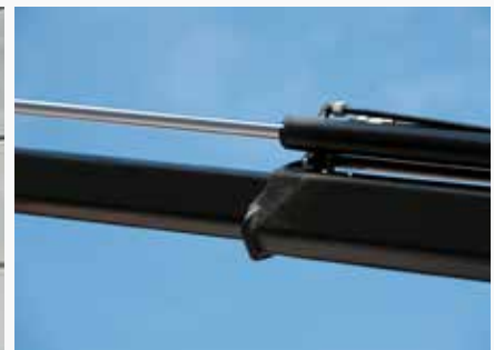
Interne oliedoorvoering Perfekte bescherming door compacte bouwwijze
