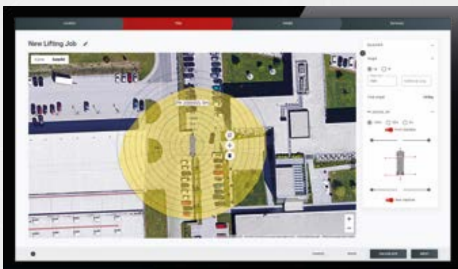
Simuleer het werkbereik en de steunpootdruk afhankelijk van de steunpootpositie en de last.
